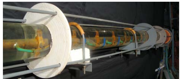
Рис. 4. Ділянка прозорого футляра з вмонтованим ТЗ (внутрішній діаметр ТЗ D = 22 мм, те саме, вхідних насадок d = 8 мм)
