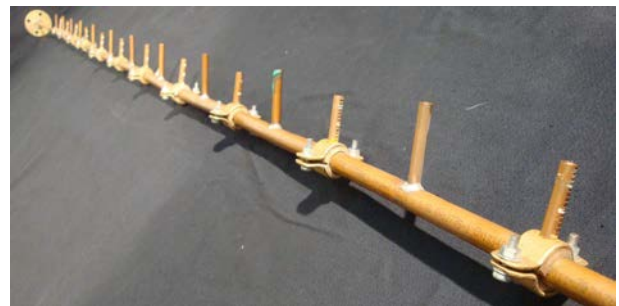
Рис. 5. Експериментальний трубопровід-збирач (внутрішній діаметр ТЗ D = 10 мм, те саме, вхідних насадок d = 4 мм)
