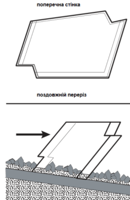
Рис.5. Конструкція поперечних стінок ромбового рибоходу.
